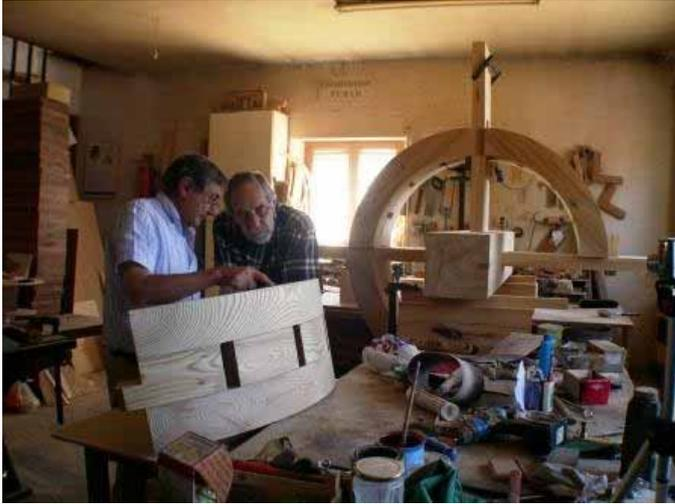
Se trata de una rueda hidráulica vertical de palas rectas cerradas por sus costados, reconstrucción hipotética de una de las ruedas que movían el taller de herrería. Su diámetro exterior es de 2,20 metros (8 pies castellanos) y 16 palas y su peso es del orden de 600 kg . Se ha utilizado madera de pinotea o pino Melis, muy resinoso y resistente a la acción del agua. Aunque existieron ruedas de hasta 3,75 metros de diámetro, se ha optado construir una de las ruedas menores.
