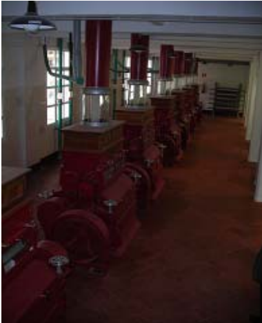
Los molinos de cilindros después de su rehabilitación.
